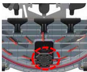
スクイジーで汚水を回収し赤く囲った部分から吸水します。
