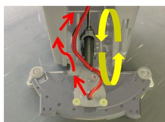
車輪が回転してポンプが駆動しホースを通り汚水が回収されます。
