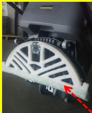
矢印の箇所に付属のダスターを貼り付けて使います。ゴミをキャッチします。
