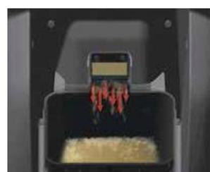
汚水は前面の受けバケツの中へ回収されます。
